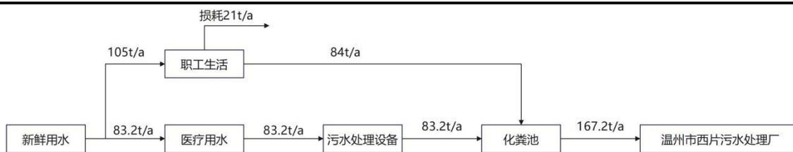
图 2-1 项目建成后全厂水平衡图
